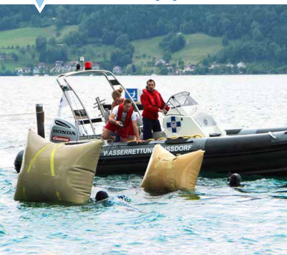
Bergung mittels Hebeballon
